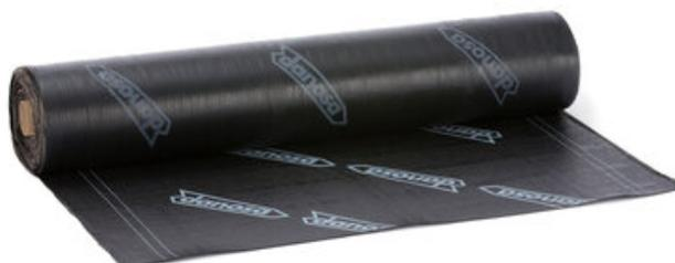
Lámina impermeabilizante bituminosa de superficie no protegida tipo LBM-40-FV (APP -5 °C). Compuesta por una armadura de fieltro de fibra de vidrio, recubierta por ambas caras con un mástico de betún modificado con plastómeros (plegabilidad -5°C), usando como material antiadherente un film plástico por ambas caras. La cara inferior va gofrada.
