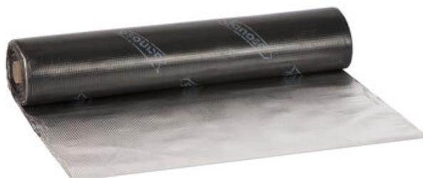
Es una lámina impermeabilizante bituminosa autoprottegida, tipo LBM(SBS)-30/M-NA. Está compuesta por un mástico de betún modificado con elastómeros (SBS). Como material de protección, en la cara externa se usa una hoja de aluminio gofrado de 80 micras de color natural. Como material antiadherente en su cara interna, se usa un film plástico de terminación.
